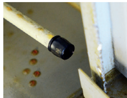
Amortissement de la porte de la machine dans un centre d'usinage
