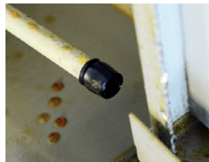
Decelerazione della porta della macchina in un centro di lavorazione
