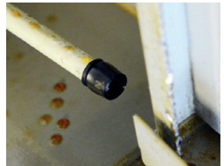
Dämpfung der Maschinentür in einem Bearbeitungszentrum
