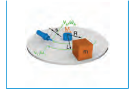
R7. Horizontal schwenkende Masse mit reibschlüssigem Antriebsmoment
