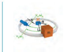
R6. Horizontal schwenkende Masse mit formschlüssigem Antriebsmoment
