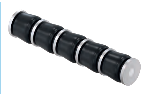
▶ Reihenschaltung von mehreren BasicStop Axial Standard inkl. integrierter Rundstangenführung zur Stoßdämpfung mit geringerer Stützkraft durch größeren Hub
