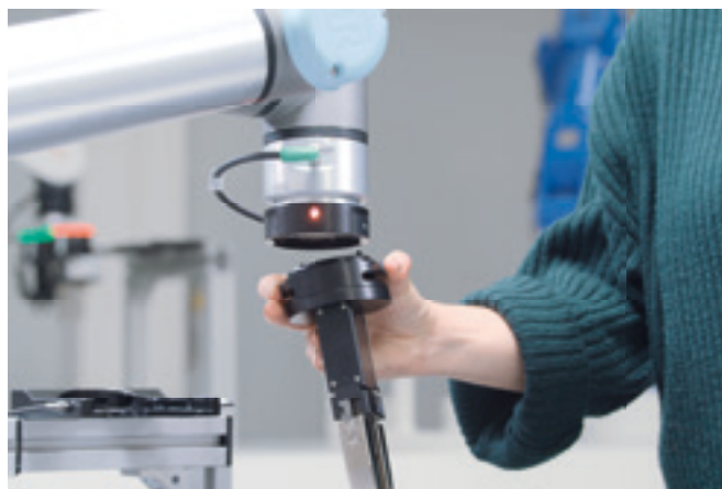
Ręczna wymiana z użyciem jednej ręki w ciągu kilku sekund.
