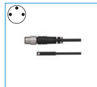
MFS02-S-KHC-P1-PNP Czujnik pola magnetycznego prosty, kabel 0,3 m - Wtyczka M8
