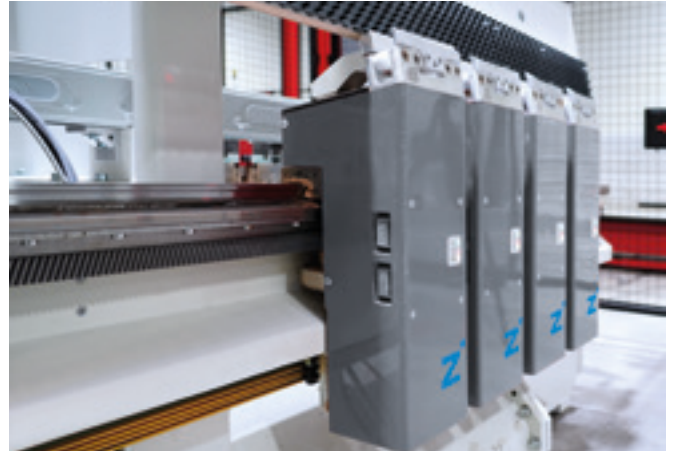
Transportsysteme mit umlaufenden Shuttles
