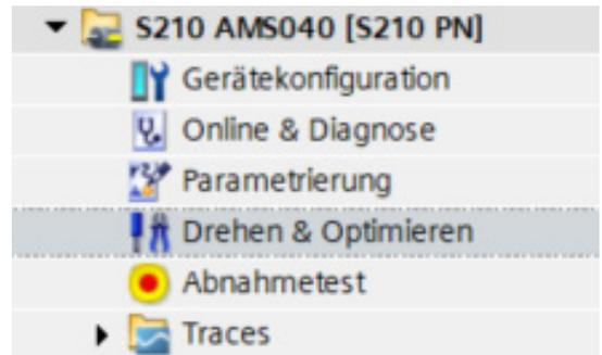
Mit der Funktion *One Button Turning* können die Regelparameter optimiert werden.
