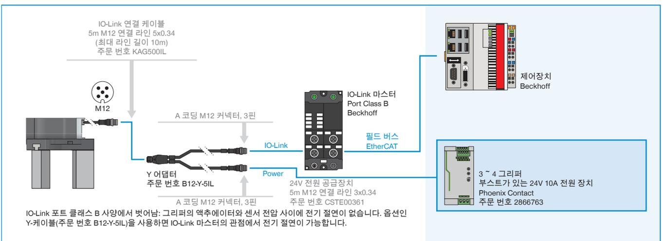
▶ Y 케이블을 통해 IO 링크 마스터 IP67에 연결된 GED6000IL-03-A 배선(SIEMENS)
