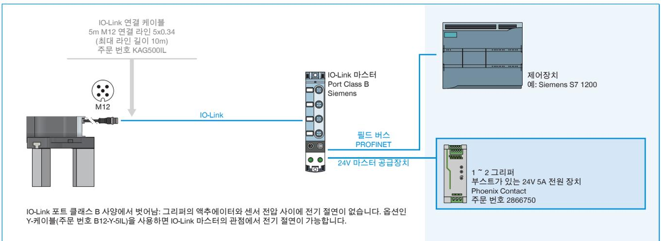
▶ Y 케이블을 통해 IO 링크 마스터 IP67에 연결된 GED6000IL-31-A 배선(SIEMENS), 3-4 그리퍼
