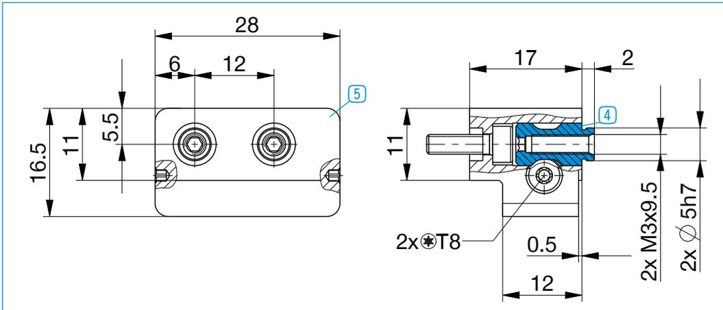
Pro Greiferbacke wird jeweils ein Wechselbacken-Losteil-Set (4) und ein Wechselbacken-Festteil (5) benötigt
