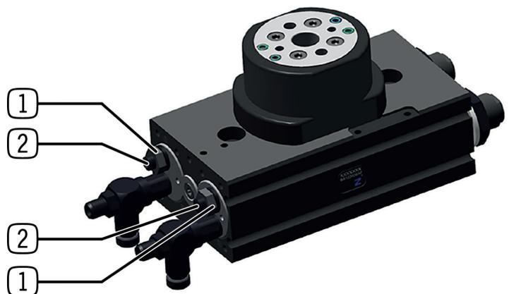
Es muss stets gewährleistet sein, dass die Einstellschrauben mit den jeweiligen Anschlagflächen in Kontakt kommen, so dass der Stoßdämpfer nicht als Endanschlag dient.
