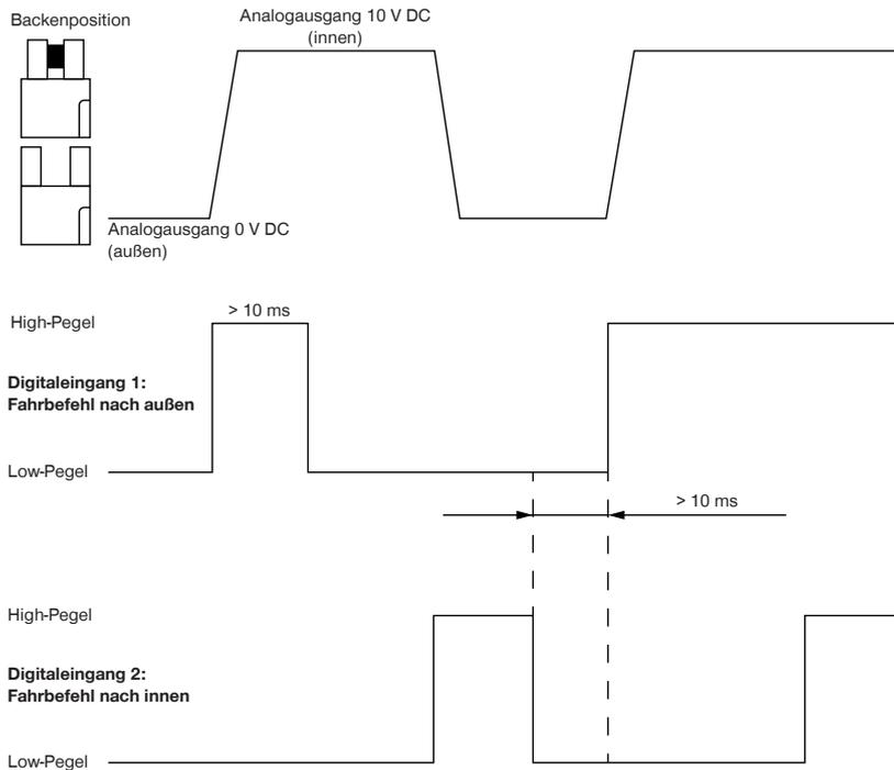
Eine Fahrt in die gewünschte Richtung erfolgt durch einen High-Pegel des entsprechenden Signals. Nach erkanntem High-Pegel findet die Greiffahrt bis zum Ende des Greifvorgangs statt.
